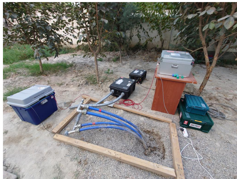
タジキスタン科学アカデミーに設置した地中熱交換器における熱応答試験の様子
