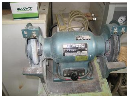
安全カバーの取付が不十分
