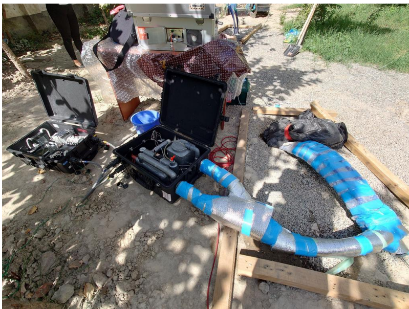
タジキスタン科学アカデミーに設置した地中熱交換器における熱応答試験の様子
